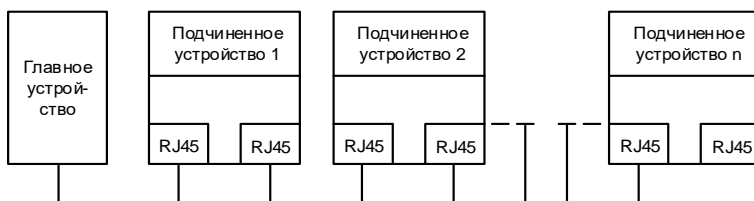
Фигура А-1 Схема электрических соединений топологии линейной сети
